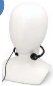
咽喉マイクは首に取り付けることにより声帯振動を捉えるマイクです。空気の振動を拾わないため、周囲に雑音があっても明瞭度が確保できます。またハウリング（音の回り込み）も抑えることができます。
